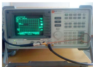
Fig 5; Spektrumanalysatorn HP8591A med en H-prob.
