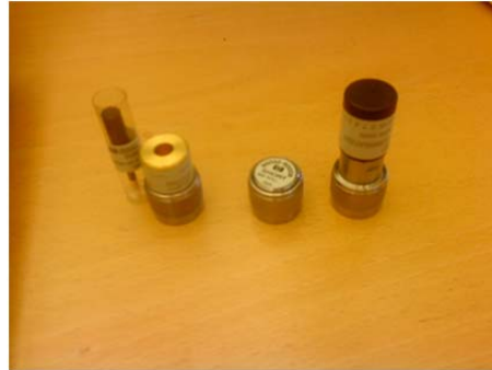
Fig 8; kalibreringslaster med start från vänster: Öppen, kortslutning och 50\Omega last. Alla ansluts som hanar. Den svarta staven ska föras in i den öppna lasten när kalibrering görs.
