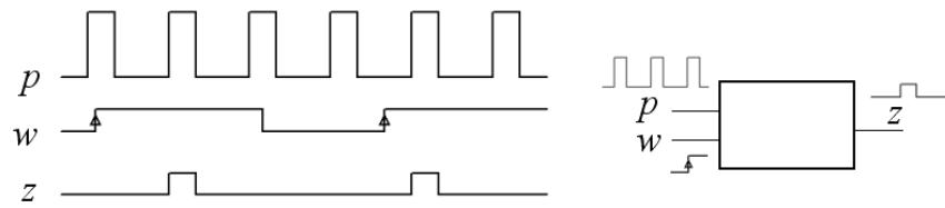
Ett asynkront sekvensnät har två ingångar och en utgång. På ena ingången finns ett pulståg  $p$ , på den andra ingången finns en långsam signal  $w$  (i jämförelse med  $p$ ). Så fort som möjligt, efter varje positiv flank hos  $w$ , ska utgången  $z$  ”släppa igenom” den efterföljande pulsen (en komplett puls) från  $p$ . Utgången  $z$  är 0 övrig tid. Se figurens exempel.
