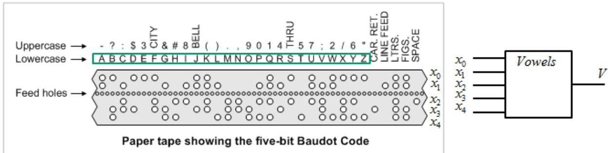
Figuren visar en hålremsa med Baudot-kod. Din uppgift är att göra en avkodare för vokaler (våra svenska vokaler Å Ä Ö ingår *inte*, Y ska anses vara vokal) som ger utsignalen  $V=1$  bara när koden motsvarar en **vokal**. Utgå ifrån att det avkodaren ska läsa är en redigerad remsa med endast det engelska alfabetets bokstäver **A ... Z** (endast bokstäver från raden "Lowercase"). Inga av specialtecknen (car. return, line feed, ltrs ...) kan förekomma. Hål = 1, inget hål = 0.
