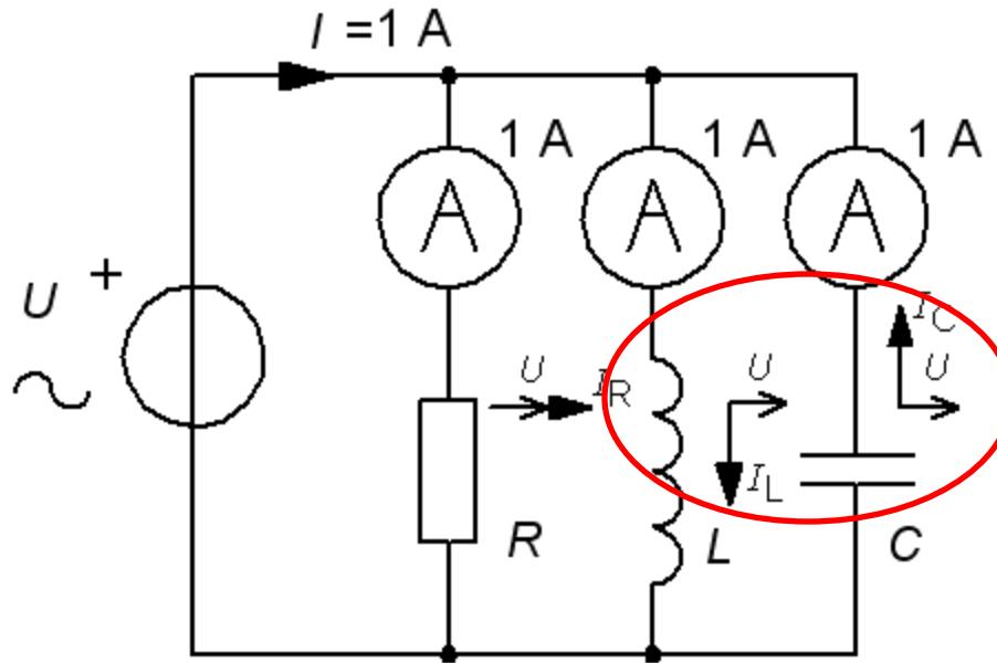
$I_L$  och  $I_C$  blir en **cirkulerande ström** frikopplad från  $I_R$ .  $I_L$ ,  $I_C$  kan vara *många gånger större än* det matande nätets ström  $I = I_R$ . Detta är parallelresonans.
