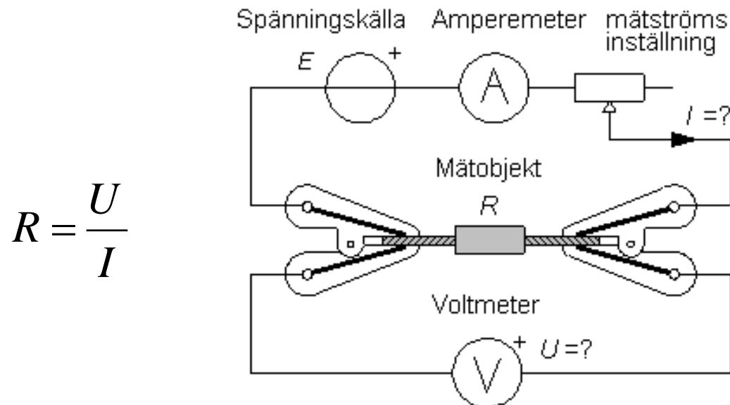
RCL-mätaren är förberedd för fyrtårdsmätning.
