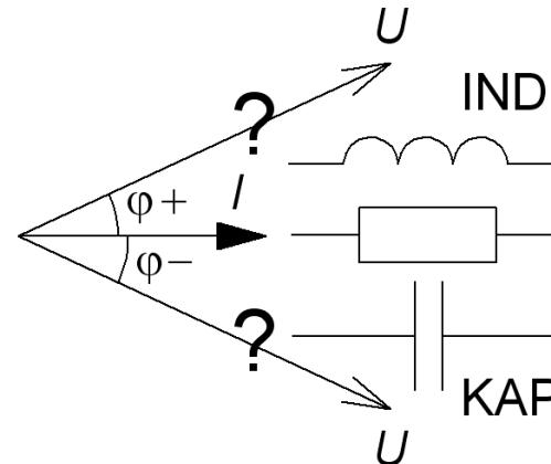
En impedans som innehåller spolar och kondensatorer har, beroende på frekvensen, antingen induktiv karaktär **IND**, eller kapacitiv karaktär **KAP**.
