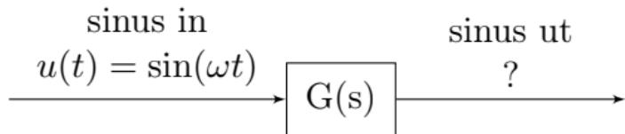
$$\Rightarrow y(t) = \underbrace{|G(i\omega)|}_{\text{förstärkning}} \cdot \sin \left[ \omega t + \underbrace{\arg G(i\omega)}_{\text{fasvridning}} \right] + \text{transient (stabil)}$$
