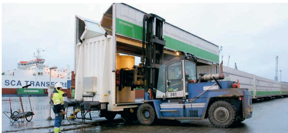
Övre bilden: SJ Gods gjorde ett försök med ett »Lättkombi«-tåg i slutet på 1990-talet. Gaffeltrucken som kunde lasta och lossa containrar under kontaktledningen följde med tåget och kördes av lokföraren.
