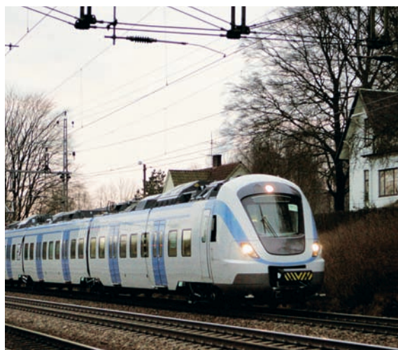
SL:s nya pendeltåg X60 är det första tåget som har alla dörrar och golvet i plan med plattformen på 73 cm höjd och all elutrustning på taket.
