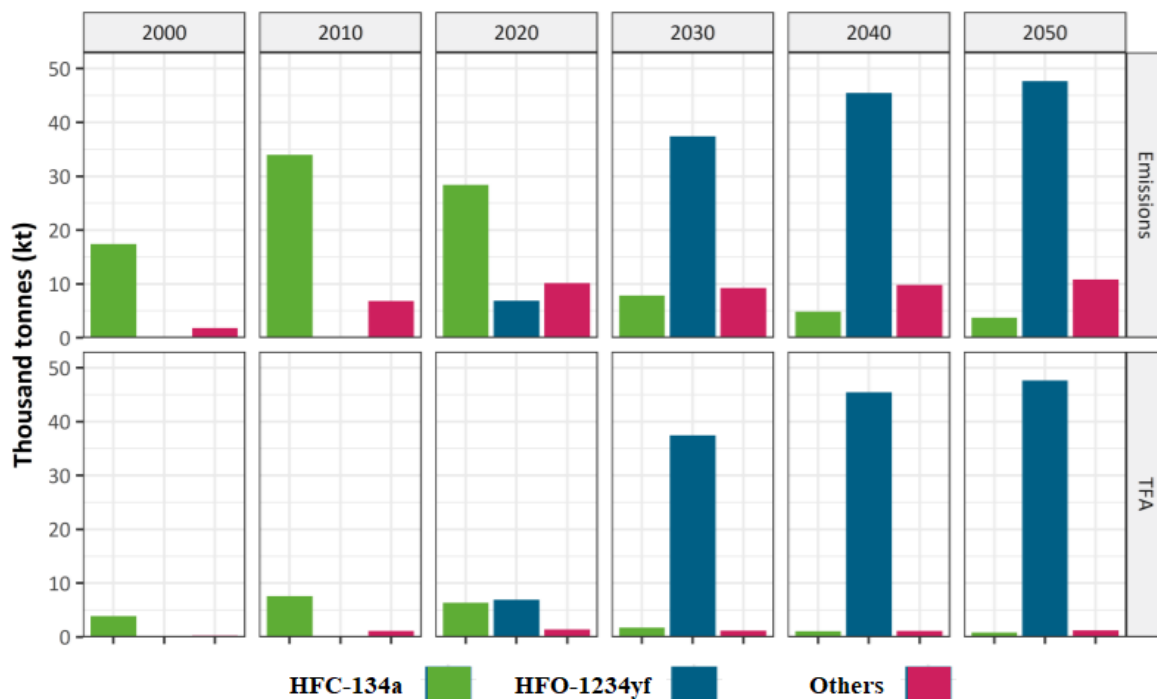
Figur 2. Utvecklingen av utsläpp från alla sektorer av de köldmedier som mest bidrar till bildandet av TFA inom EU-28 och resulterande mängder bildat TFA i kiloton fram till 2050 [6]
